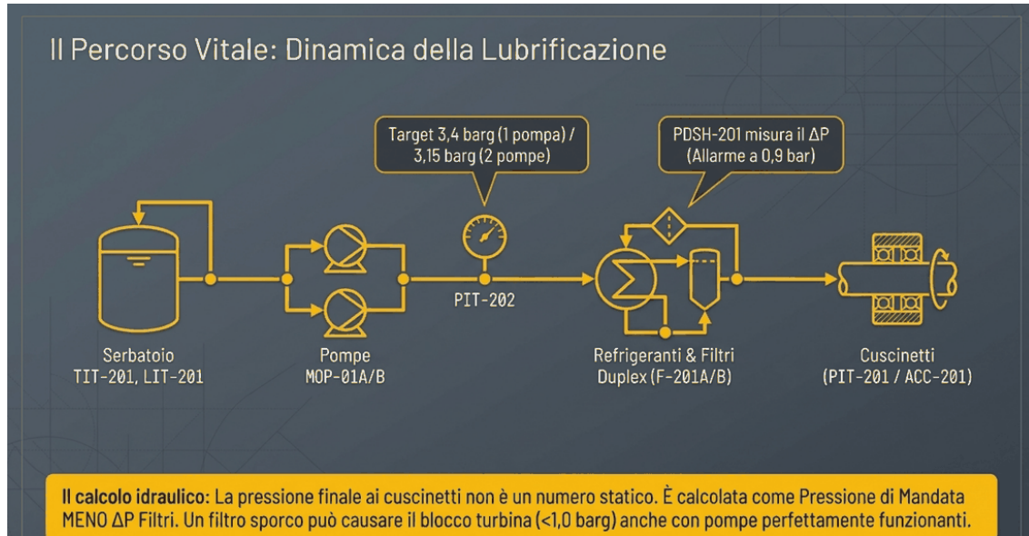
Figura 1: Percorso del fluido: dal serbatoio ai cuscinetti.
