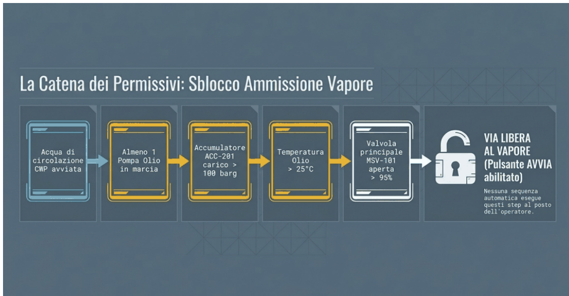
Figura 5: Catena dei permissivi che sblocca l'ammissione vapore.
